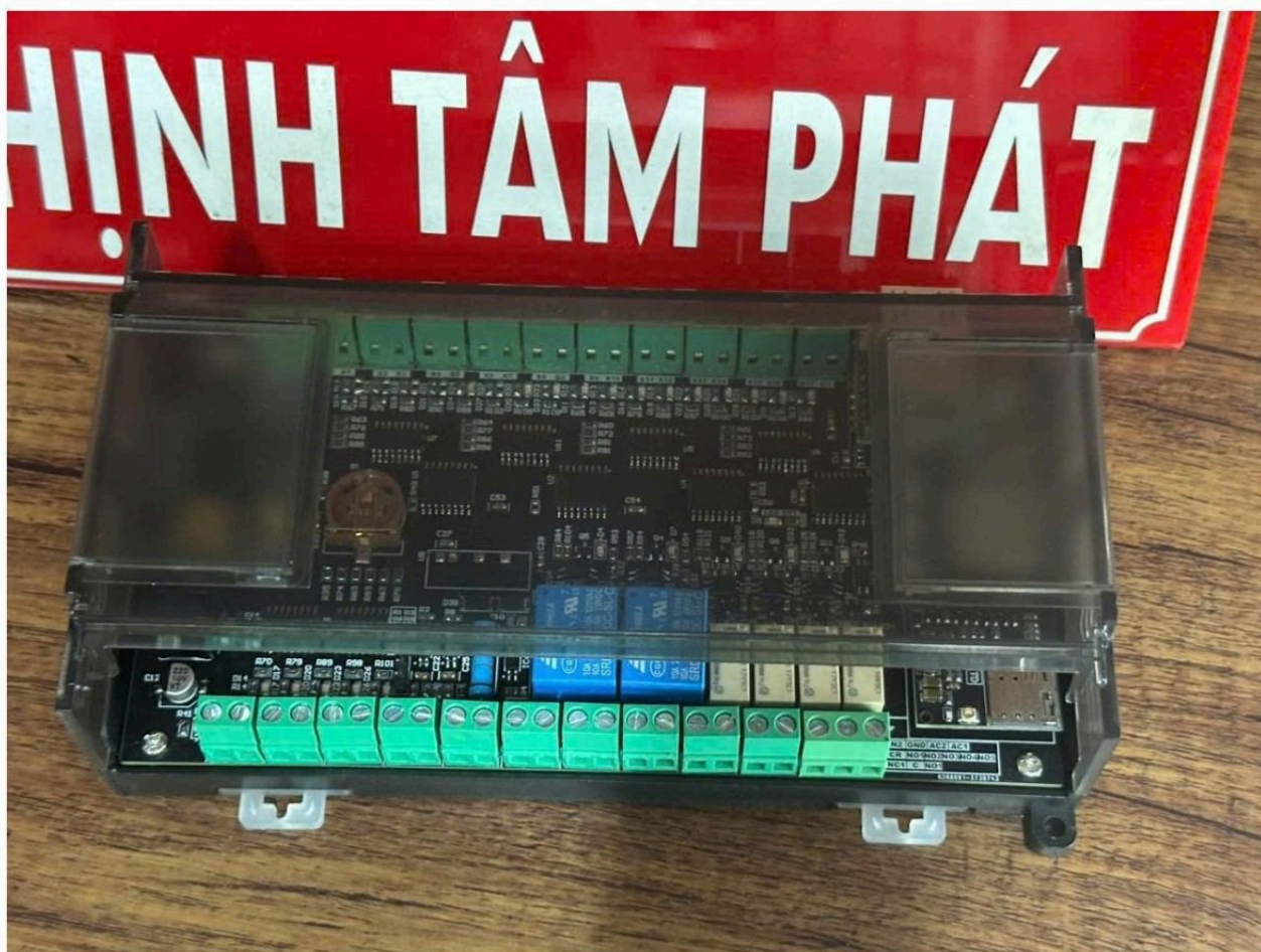
TTP-16SMS - bộ cảnh báo sự cố máy qua SMS và cuộc gọi
